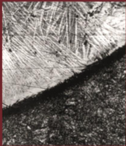
Микроструктура наплавленного слоя белого чугуна на ст. 20 (травленный шлиф), X 200
