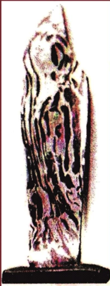
Нож из цветного булата с перлитно-карбидной структурой. Изготовители Ю.Г. Гуревич, В.И. Чуманов
