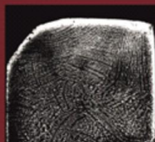
Рис. 13. Макроструктура кованного булата, полученного П.Н. Швецовым
