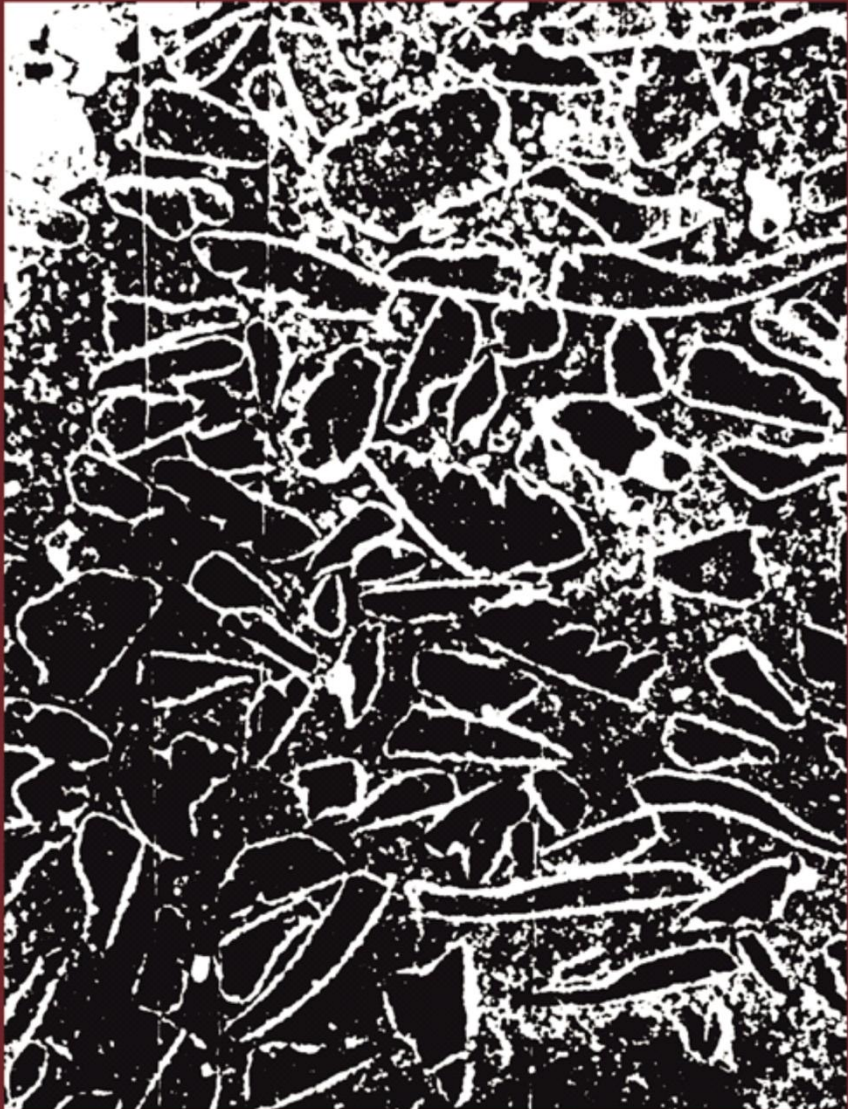
Рис. 19. Макроструктура булатного слитка с углеродистыми прослойками. Содержание углерода 1,5 — 1,6 %
